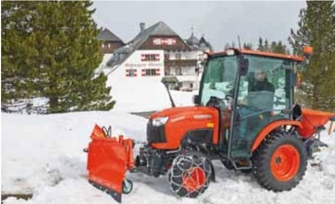
KUBOTA bietet in der Leistungsklasse von 23–62 PS Kommunaltraktoren für den Profieinsatz mit Aussenbreiten von 1,23 m bis 1,55 m.
