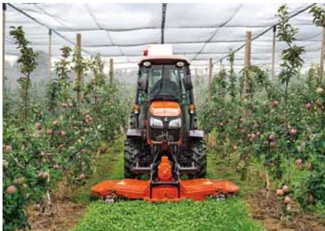
Im Bereich der Schmalspurtraktoren stehen 5 Modelle mit Kabine (74, 87, 96, 106, 115 PS) und 2 Modelle als Bügelversion (74 und 106 PS) zur Verfügung. Kleinste Aussenbreite mit Serienbereifung sind 1,31 m bei 24" und 1,42 m bei 28".
