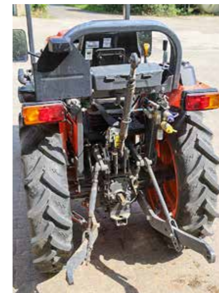
Zweifach-Zapfwelle, 1 150 daN Hubkraft, bis zu zwei dw-Ventile sowie ein Zugpendel machen den LX universell einsetzbar.
