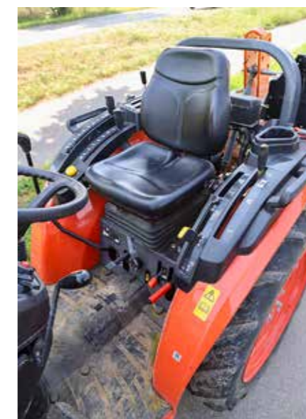
Der Fahrerplatz ist übersichtlich, rechts der Gang – links der Gruppenhebel.
