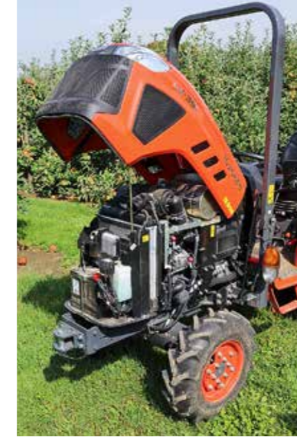
1,5 l Hubraum und 35 PS, aber nur 60 cm Baulänge – der Vierzylinder-Motor von Kubota.
