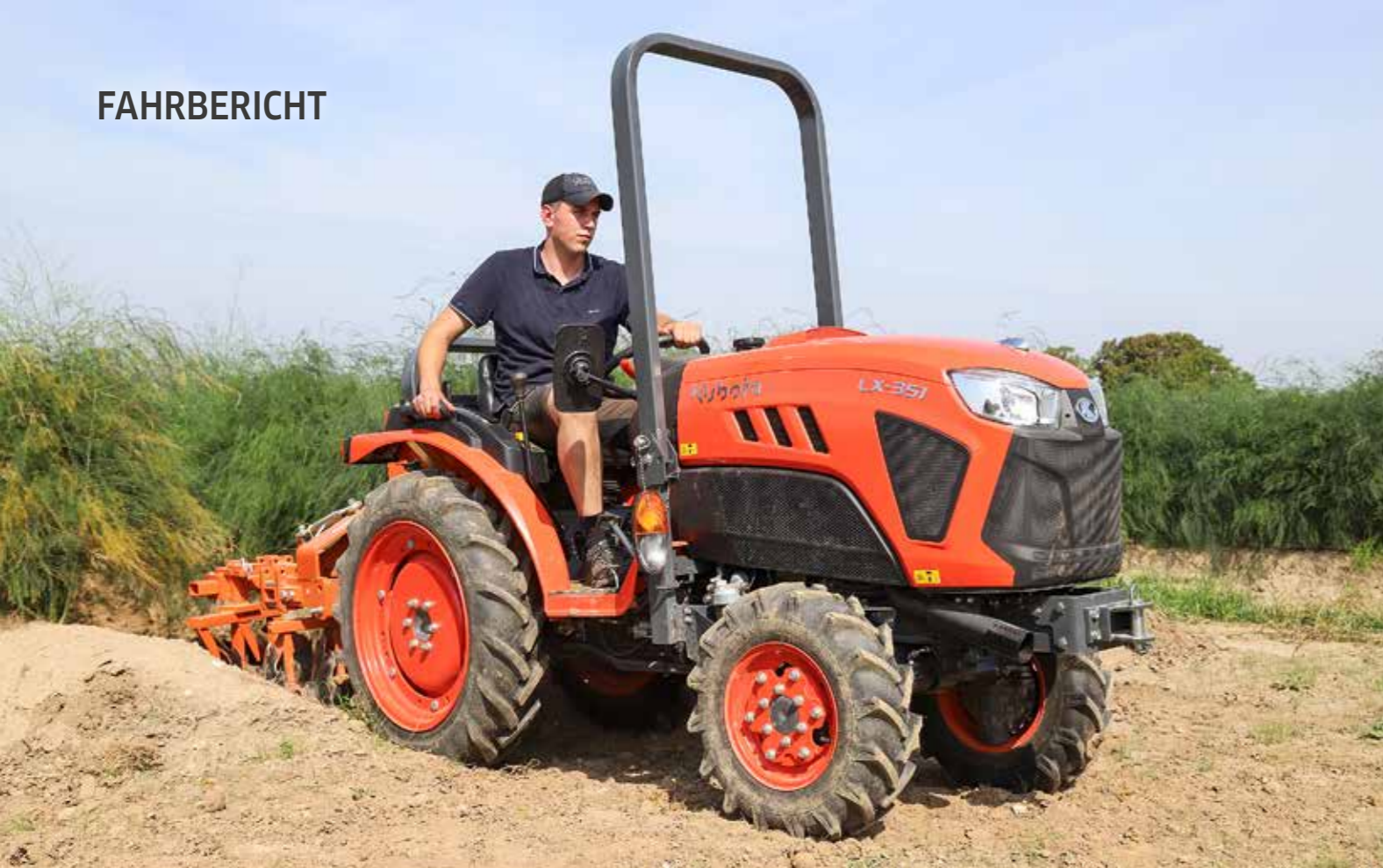
Überall wo es eng wird, kommt der LX-351 DM von Kubota groß raus. Hier mit einer Braun Scheibenege im Spargel. Fotos: Wilmer
